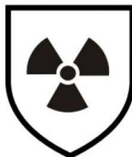
Handschuhe zum Schutz vor einem direkten Kontakt mit Strahlen (Röntgen-, Alpha-, Beta-, Gamma- oder Neutronenstrahlen).
